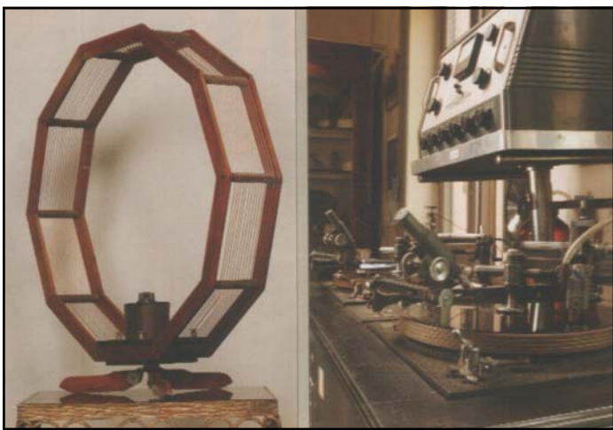
Transmisor Marconiano con antena y toma a tierra con el cual Marconi desde la habitación de los Bachi en Villa Grifone (Pontecchio, Boloña, It.) envió la señal a la colina de los Celestinos, distante aproximadamente 2 Km. del lugar donde estaba colocado el receptor Coherer. Receptor Marconiano Coherer con antena y toma a tierra con el que fue recibida la primera señal de radio transmitida a distancia. Reproducción fiel y funcionante realizada por Mario del Rosario, radioamador y 6DRZ de Lanciano (Chieti, Italia)
